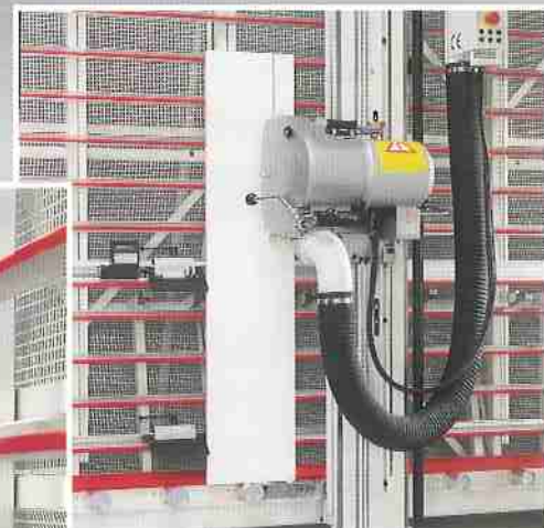
Vertikalschnitt von schmalen Plattenstücken mittels Hilfsanschlügen
