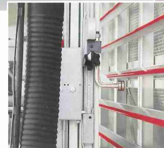
Streifenanschlüge für identische Horizontalschnitte
